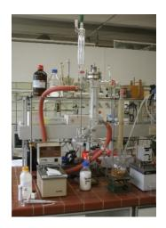
fläche berücksichtigt werden. Die letztgenannten Eigenschaften lassen sich nicht theoretisch ermitteln oder abschätzen, sondern erfordern die Möglichkeit einer visuellen Beurteilung des Verdampfungsprozesses. Dies lässt sich am besten in Glasanlagen von COROSYS umsetzen, die nach einem Baukastensystem individuell zusammengestellt werden können.
